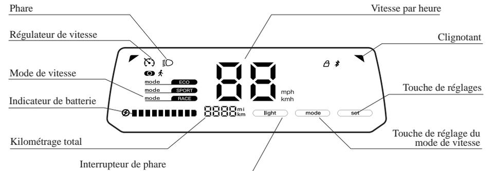
Set: Touche tactile de réglages, appuyez pour basculer entre les unités de vitesse et de kilométrage, maintenez enfoncé pour basculer entre le démarrage zéro et le démarrage non zéro.
