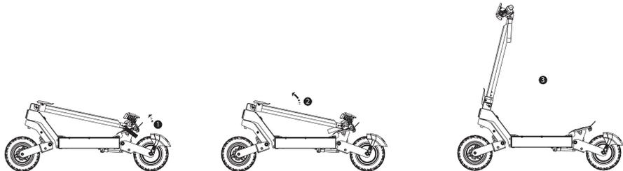
1. Retirez la gaine de verrouillage au bas du repose-pieds arrière.
